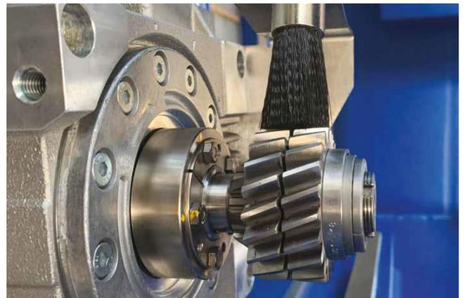
Instalad en una polea en un accionamiento de un teleférico mediante SIT-LOCK® 4.
