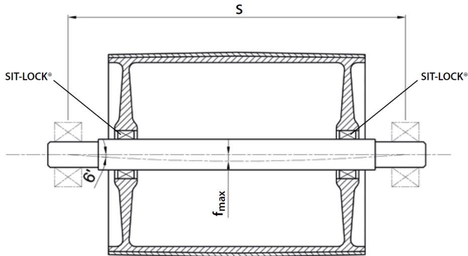
**Polea de cinta transportadora instalada con un buje de sujeción SIT-LOCK®**
