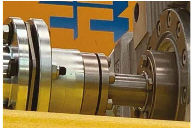
Montaje de dos poleas mediante SIT-LOCK® 3 sin espaciadores.
