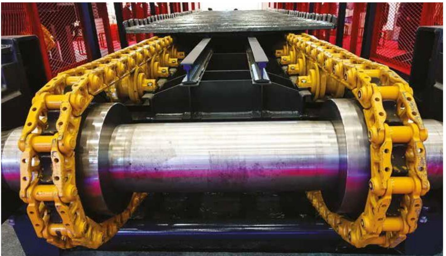
Fijación de los piñones de cadenas de un transportador con SIT-LOCK® 4 COMPACT.
