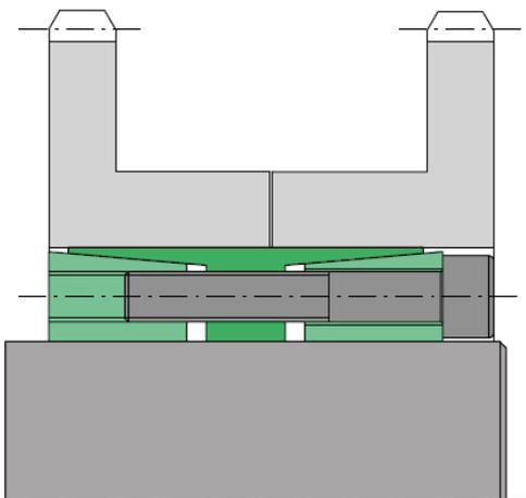
Bloqueo simultáneo de dos piñones mediante SIT-LOCK® 4.
