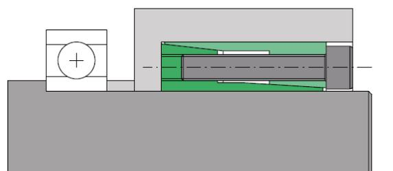
Puede usar el SIT-LOCK® 15 para bloquear un buje mientras se bloquea axialmente un rodamiento. Para más información, póngase en contacto con nuestro Departamento Técnico.
