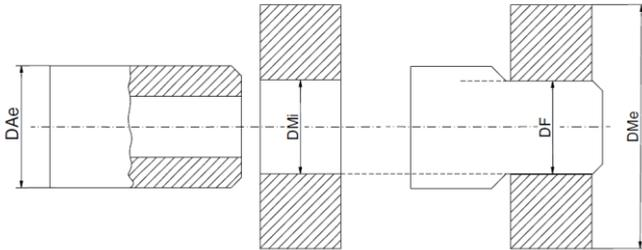
El ajuste por interferencia eje-buje se pueden lograr enfriando el eje o calentando el buje. Este tipo de conexión no es ampliamente utilizado por las siguientes razones:
