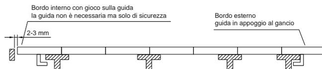
Configurazione adatta per tiro nastro limitato e velocità fino a 20m/min.
